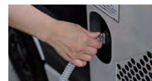
ノズルを差し込み、ボタンを押して水素を充填 水タンク内にたまった水を自動排水装置で脱水
