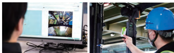
管理PCから稼働状況や記録動画を確認可能 IDカードで認証して記録開始
